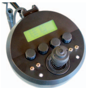
Optionale Fernbedienung für Pulsauslösung und Verfahrachsen
