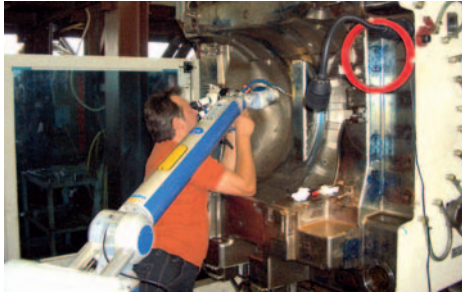
Mobiles Reparaturschweißen in der Maschine an einer Spritzgussform.
