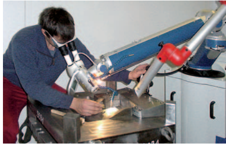
Schweißen in einer Werkzeugvertiefung.
