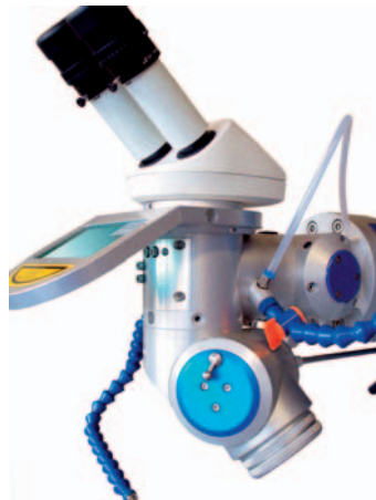
Zusätzliche Kipp-/Schwenkoptik am beweglichen Arbeitskopf
