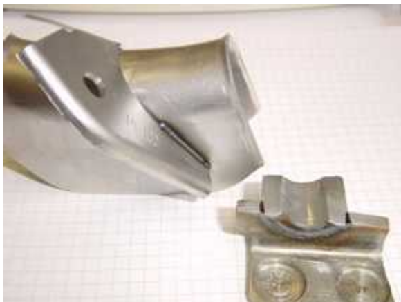
Gehäusewand (297x251mm 2 ): Fertigungszeit 44 Sekunden bei 55 Konturen in AlMg 3 , t = 1 mm.
